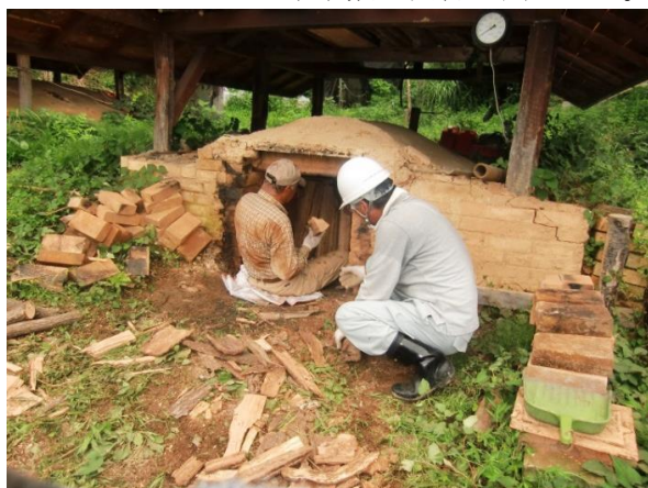
H25. 7. 31 平治窯小炭材入れ作業
