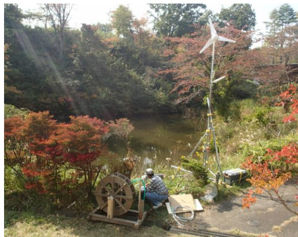
風力発電(出力400W)水車直径1m(発電機取付予定) 太陽光発電パネル(出力90W)の組み合わせの設備。 これらの施設を利用した環境教育プログラムが示されますので有効に活用して下さい。
